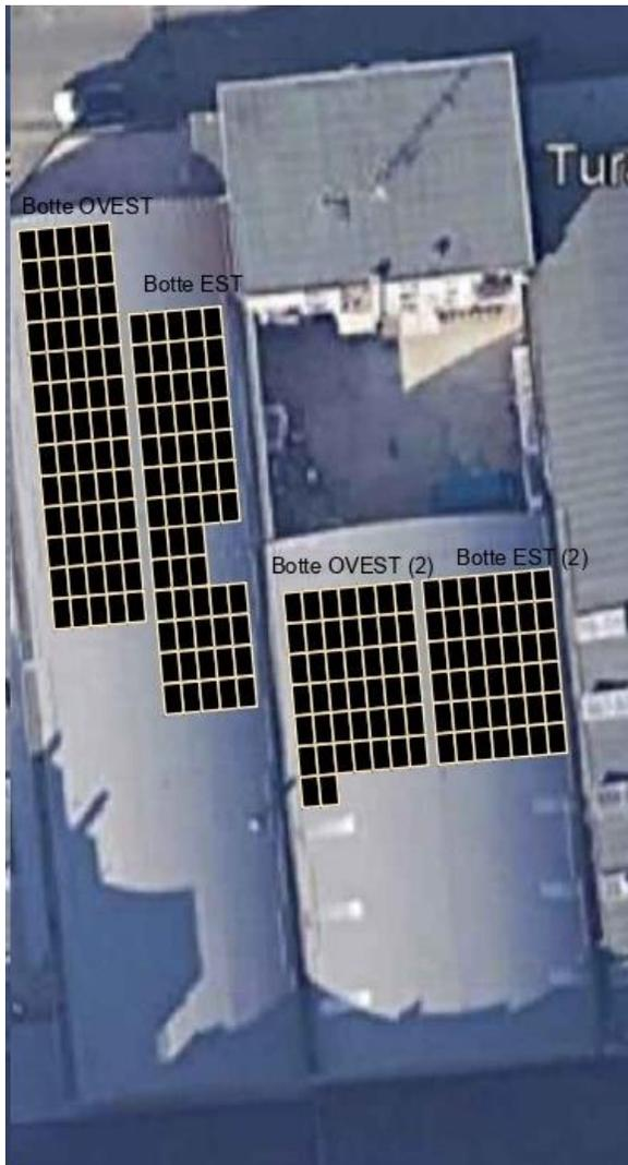
Sul tetto dell'APS La Rotonda di Baranzate (MI) la 3E Environment Energy Economy S.r.l., che ha curato in ogni sua fase lo sviluppo della SOL\_Solari e Solidali, ha iniziato l'installazione di un impianto fotovoltaico di **potenza di picco minima complessiva pari a circa 86, 92 kW**, costituito da 212 moduli della potenza minima di 410W ciascuno, **garantiti per 30 anni**.
